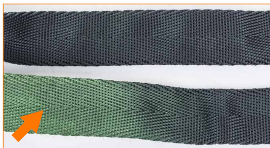
Sangle sale et avec la présence de peinture et d'incrustations.
