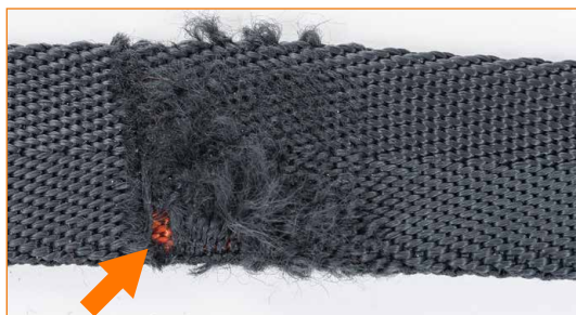
Sangle extrêmement usée : la partie interne de couleur orange est visible. La couleur différente de la partie interne est un indicateur de danger et dans le cas où elle devient visible, l'EPI doit immédiatement être mis au rebut.
