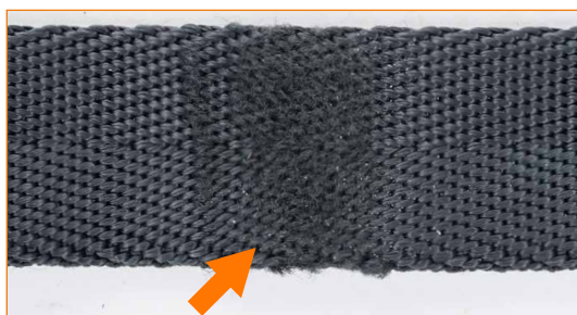
Sangle présentant des signes d'usure légère dans la zone de contact avec les angles de l'ancrage.
