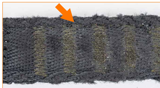
Schmutzige Sicherheitsnaht: Öl und Fett können die Naht zersetzen, zudem ist eine Zustandsprüfung unmöglich.
