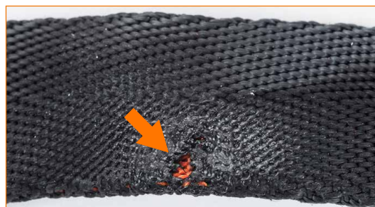
Sangle présentant des traces évidentes de brûlure dues à une exposition à une source de chaleur. Dans des cas extrêmes, la partie interne de couleur orange (indicateur de danger) devient visible.
